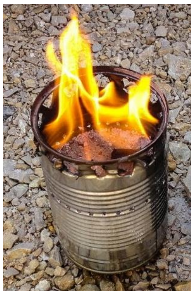
Горелка из песка, смоченного в бензине. Этот «очаг» использовался солдатами еще во время военных действий в северной Африке, поэтому его часто называли Benghazi Stove
