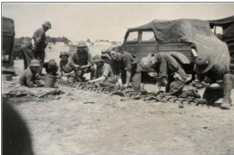
В пустыне техника быстро изнашивалась. На этой фотографии артиллеристы меняют резиновые подушки на гусеницах тягача. Это была очень тяжелая работа, в которой должны были принимать участие все без исключения. Май/июнь 1941 г.
