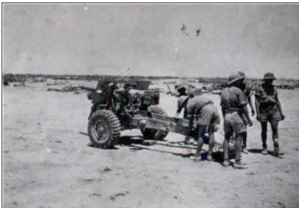
Немцы осматривают трофейную британскую 25-фунтовую гаубицу (калибр 87.6 мм), которую было решено применить в бою после изучения захваченного руководства по ее использованию. Для этой гаубицы у немцев оказалось больше снарядов, чем снарядов для всех пушек собственной батареи. Благодаря хорошо сбалансированному лафету, с этой пушкой было легко действовать в бою, особенно в условиях быстрой смены целей. Один человек мог приподнять лафет и повернуть пушку, так как у нее были надувные шины, горизонтальная наводка осуществлялась очень легко и быстро. Май 1941 г.
