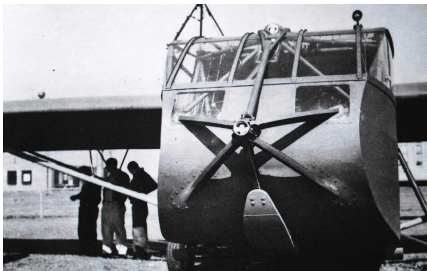
Усиленный нос планера CG-4A конструкции Людинтона-Грисуолда/Ludinton-Griswold
